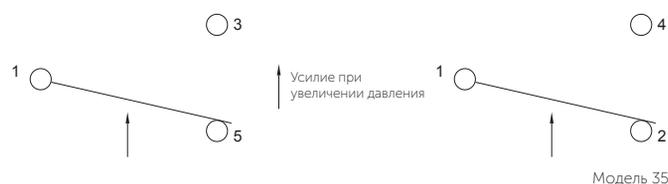
Схема подключения электрических контактов
