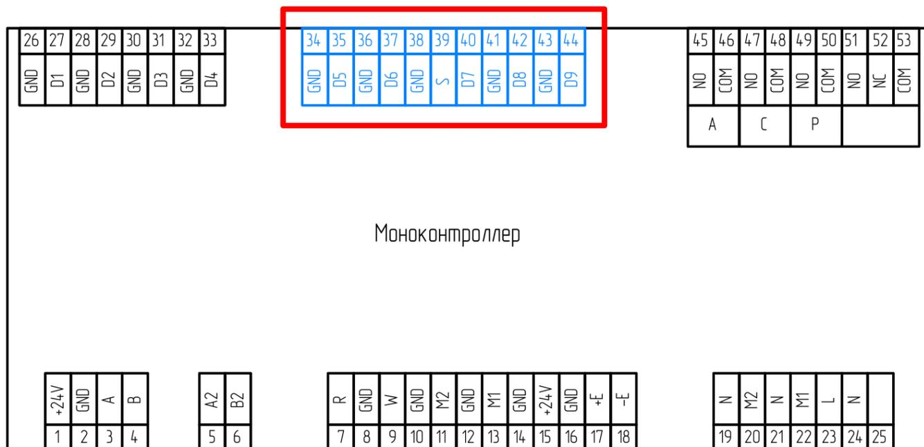
3.4. Шлицевой отверткой 3 открутите винты для установки датчика D7 (Контакты 38 (GND), 39 (V+) и 40 (D7))
