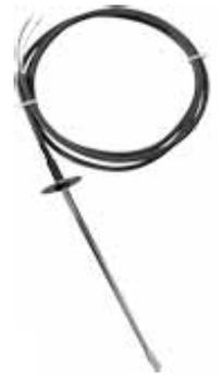
Канальный датчик температуры ETF1144/99-NTC предназначен для использования в воздушных потоках, для измерения температуры газообразных сред – например, в каналах систем вентиляции и кондиционирования воздуха. Принцип измерения температуры основан на зависимости электрического сопротивления чувствительного элемента, находящегося в защитной трубке, от температуры.
