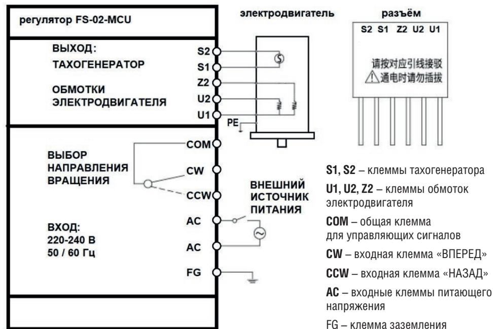
Выбор направления вращения с помощью перемычки между соответствующими клеммами: COM-CW «вперед»; COM-CCW «назад».
