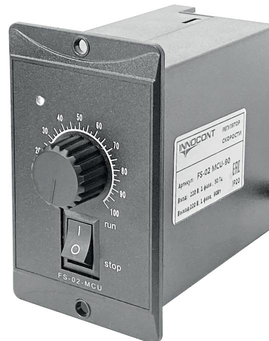
Предназначен для регулировки скорости однофазных асинхронных электродвигателей серии MC, которые оснащены тахогенератором в качестве датчика обратной связи. Фазосдвигающий конденсатор обмоток электродвигателя встроен в регуляторе.
