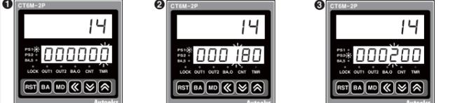
В рабочем режиме (RUN) перейдите в режим настройки значения уставки с помощью клавиши **MD**. Затем нажмите клавишу **MA**, чтобы перейти в режим настройки значения уставки (PS2).
