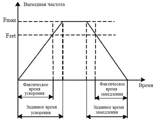
Рис. 6-2 Схема времени ускорения/замедления
