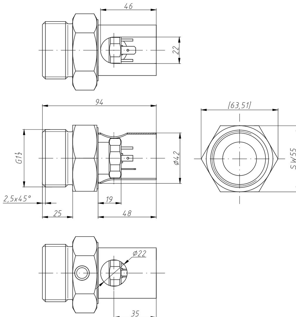
Корпус без защитного кожуха, присоединение G1 1/4", кабельный ввод M16x1,5
