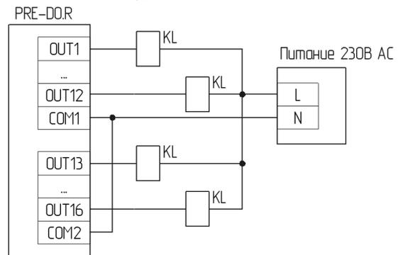
Рис. П1.1 Внешний вид и схема подключения модулей серии PRE-16DO.R-RS24
