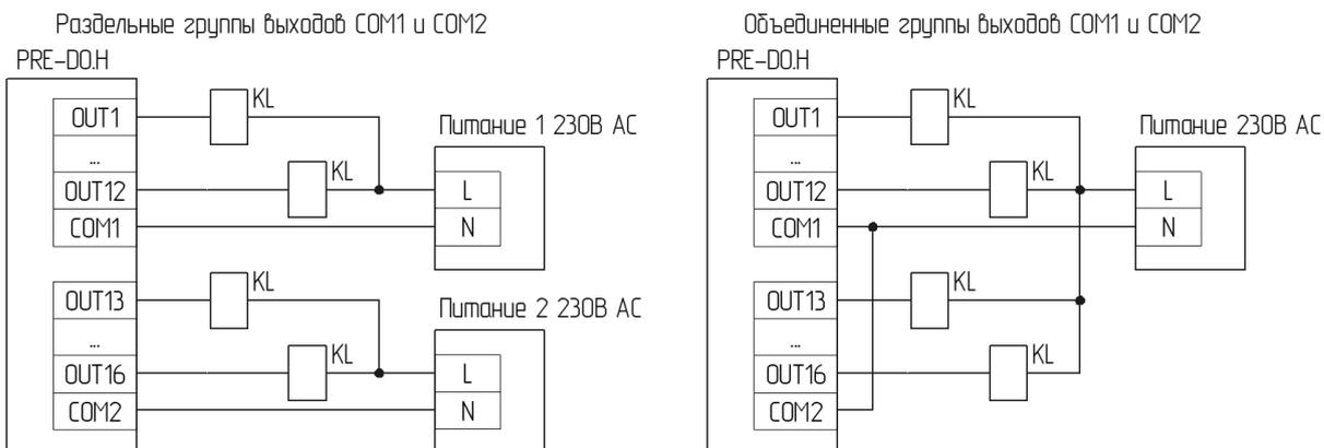
Рис. П1.2 Внешний вид и схема подключения модулей серии PRE-16DO.H-RS24
