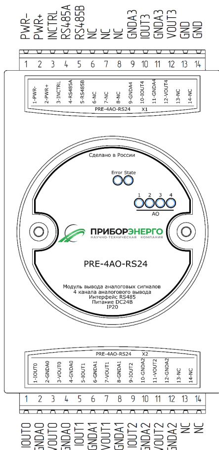
Рис. 2.2. Внешний вид и схема подключения модуля PRE-4AO-RS24
