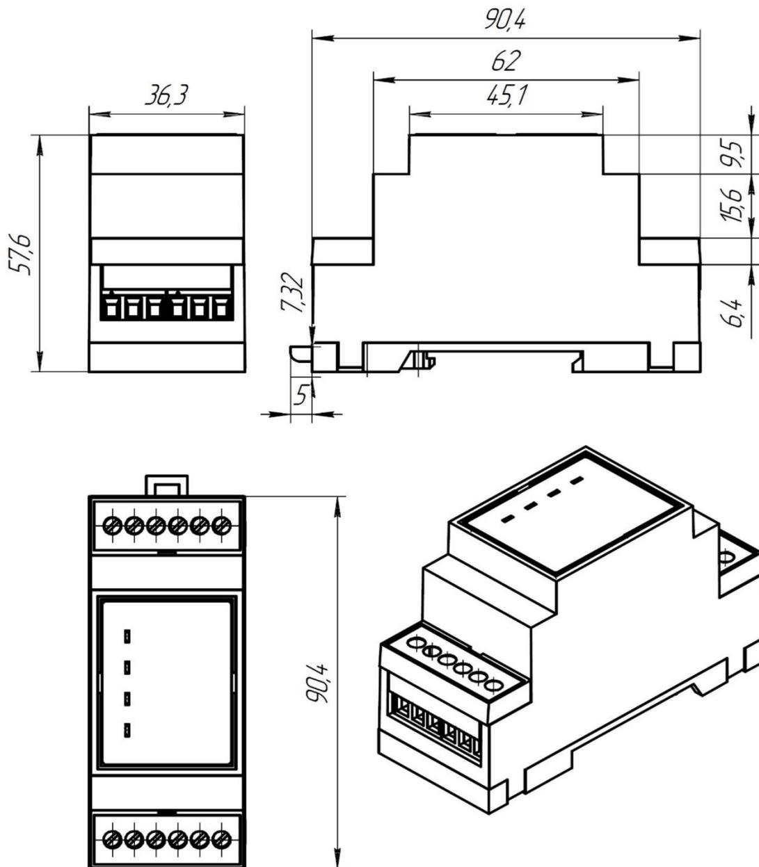
Рисунок А.1 – Габаритные размеры преобразователя Ethernet/RS-485/DCE332
