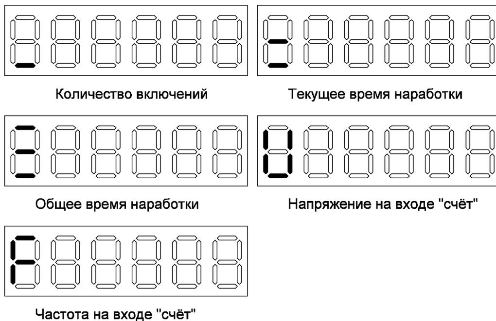
Рис.3 Режимы индикации моточасов WTM-10W
