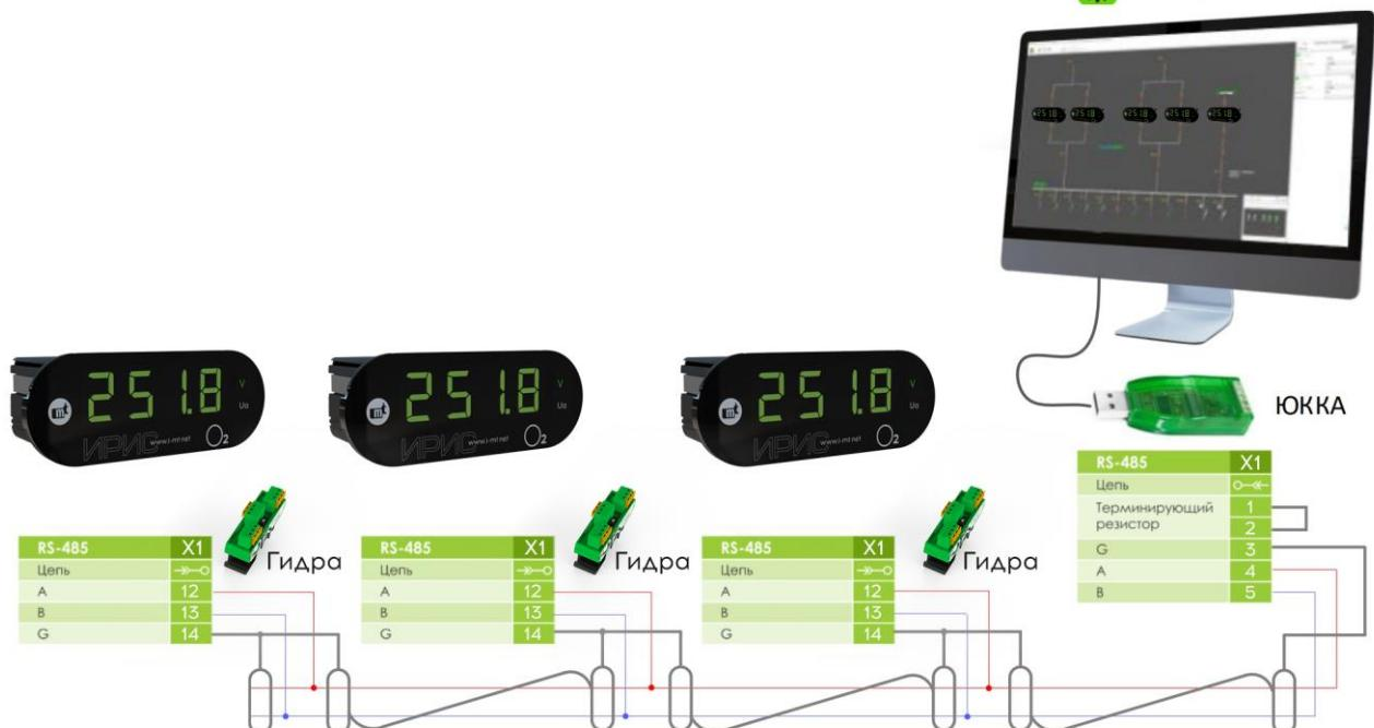
Рисунок А.6 - Схема подключения цепей RS-485 к ПТК KIWI-Monitor
