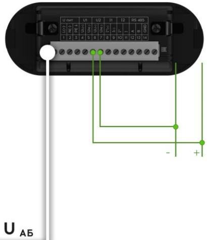
Рисунок Б.3 - Установка прибора в шкаф оперативного тока
