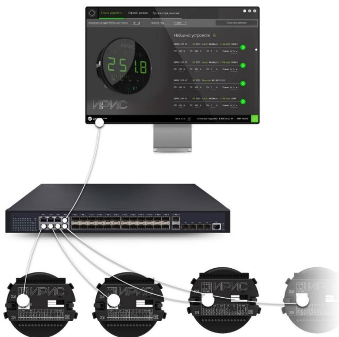
Рисунок 12.5 – Схема организации сети Ethernet
