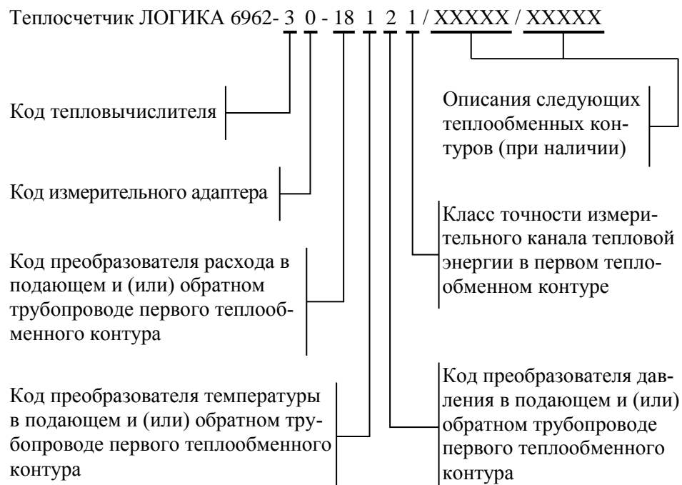
Рисунок 2.1 – Структура обозначения теплосчетчиков
