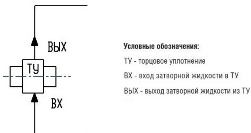
Рисунок 3 - Схема обвязки двойных торцовых уплотнений 52
