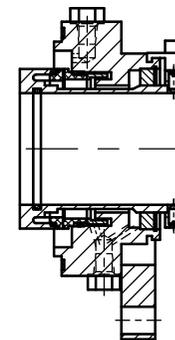
Рисунок 2 – Ротор насоса
