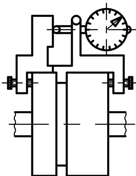
Рисунок 4 – Приспособления для центровки
