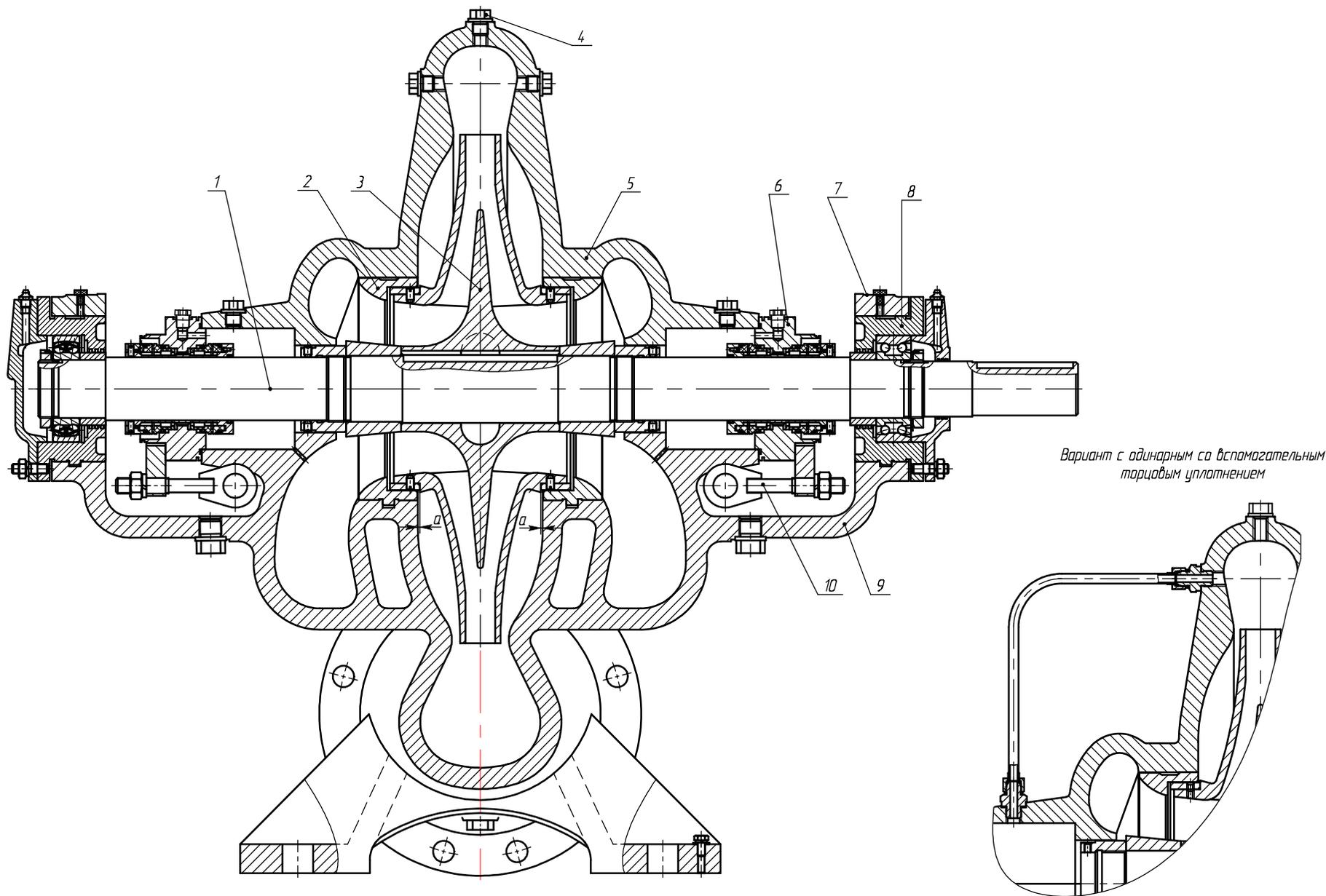
Рисунок 1 – Разрез насоса
