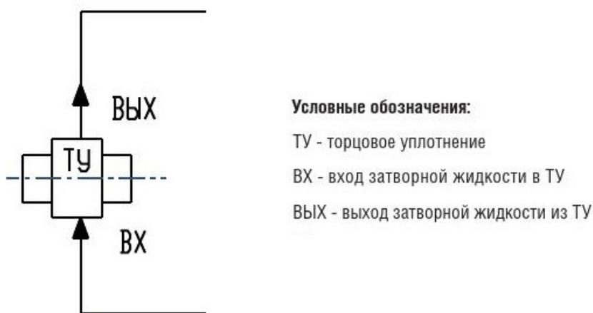
Описание работы - Циркуляция чистой барьерной жидкости от внешней системы. Давление системы превышает давление в камере уплотнения.
