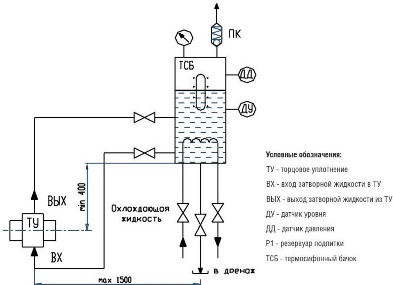
Описание работы - Внешний резервуар с барьерной жидкостью без давления с циркуляцией от импеллера торцового уплотнения.
