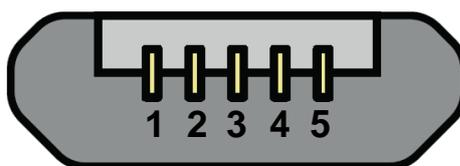
Рис. 2.5 Разъем micro-USB
