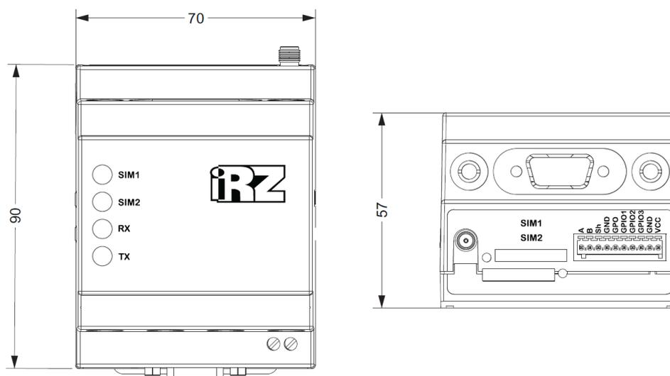
Рис. 3.2 Габаритные размеры модема ATM – чертеж
