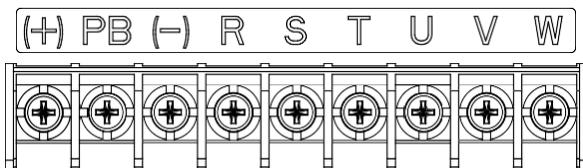
Рис 4.9 Клеммы силовых цепей ПЧ 022G/030P и ниже
