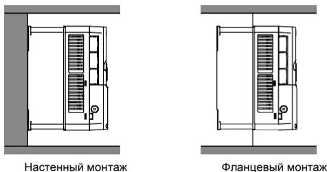
Рис 4.2 Способы установки
