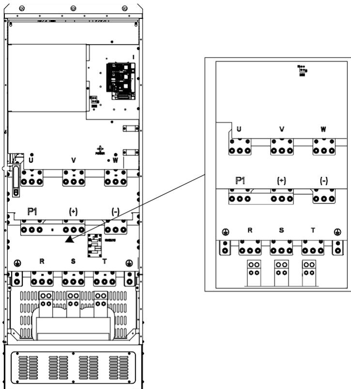
Рис 4.14 Клеммы силовых цепей ПЧ 355G/400P–500G
