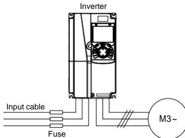
Рис 4.22 Подключение предохранителей
