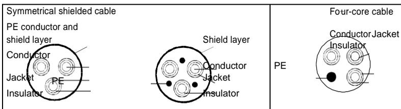
**Примечание:** Если проводимость экранирующего слоя кабелей двигателя не может соответствовать требованиям, необходимо использовать отдельные провода PE.
