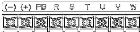
Рис 4.10 Клеммы силовых цепей ПЧ 030G/037P–037G/045P
