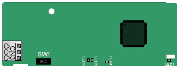
Коммуникационная плата EC-TX505 удобна для пользователя, имеет пружинные клеммы.
