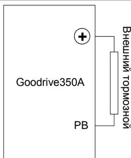
Установка тормозных модулей
