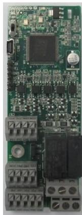
Плата PLC EC-PC501-00 Bluetooth/WI/FI EC-TX501-1/502
