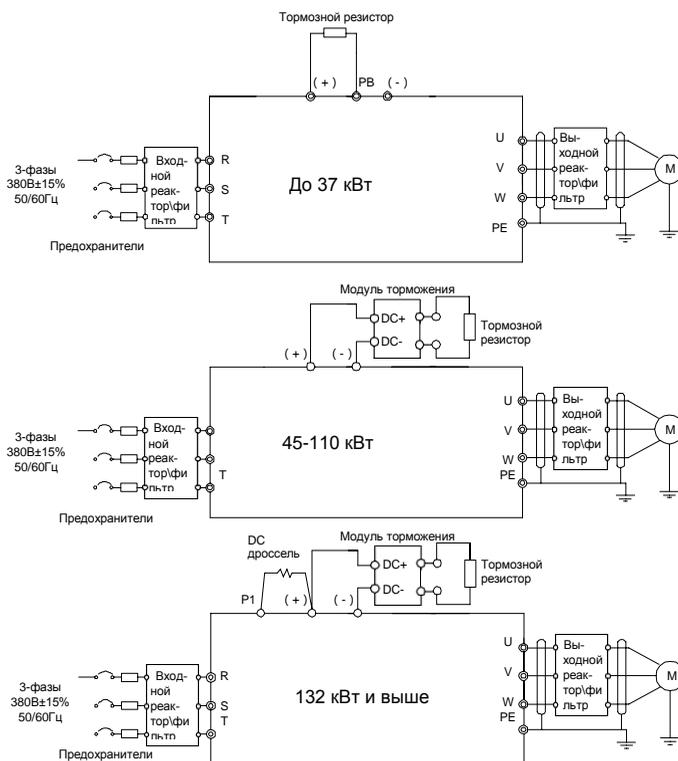
Рис 4.7 Схема подключения силовой цепи 380 В(-15%)–440 В(+10%)
