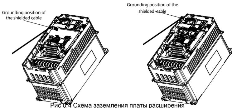
2. Подключите карту расширения следующим образом:
