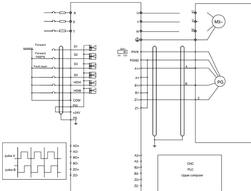
На следующем рисунке показана внешнее подключение платы расширения, используемой в сочетании с двухтактным датчиком.
