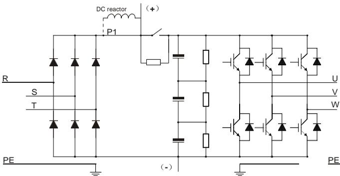
Рис 3.4 Схема силовой цепи (от 132G/160P до 500G)
