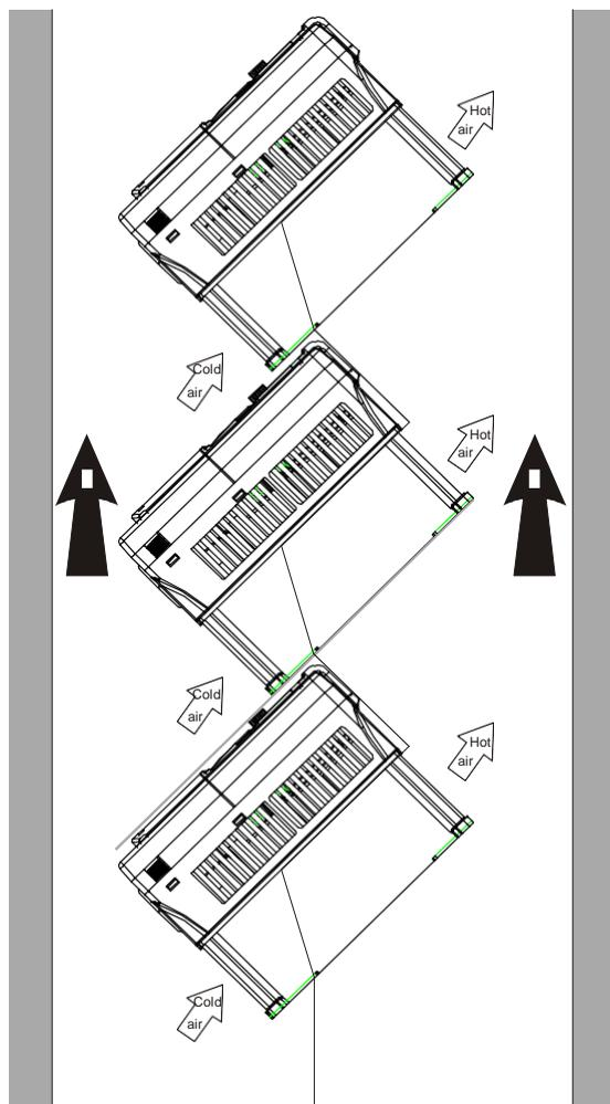
Рис 4.6 Наклонная установка
