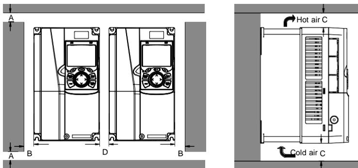
Рис 4.4 Параллельная установка
