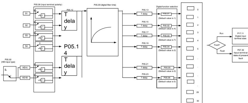
Эти параметры используются для установки соответствующей функции цифровых многофункциональных входных клемм.
