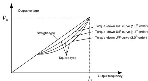
ПЧ серии GD350A также обеспечивает многоточечную кривую U/F. Пользователи могут изменять кривую U/F, выводимую ПЧ, путем установки напряжения и частоты трех точек в середине. Вся кривая состоит из пяти точек, начиная с (0 Гц, 0 В) и заканчивая (основная частота двигателя, номинальное напряжение двигателя). Во время настройки требуется, чтобы  $0 \leq f_1 \leq f_2 \leq f_3 \leq \text{основная частота двигателя}$  и  $0 \leq V_1 \leq V_2 \leq V_3 \leq \text{номинальное напряжение двигателя}$
