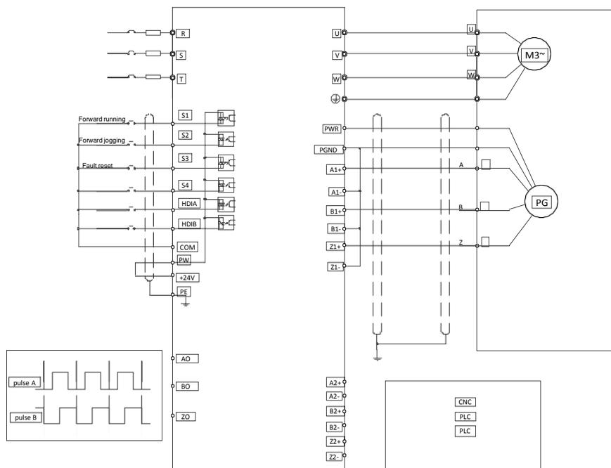
На следующем рисунке показана внешнее подключение платы PG, когда она используется в сочетании с двухтактным датчиком.
