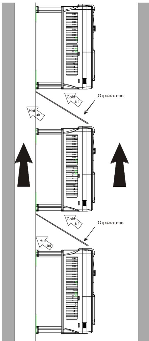
Рис 4.5 Вертикальная установка
