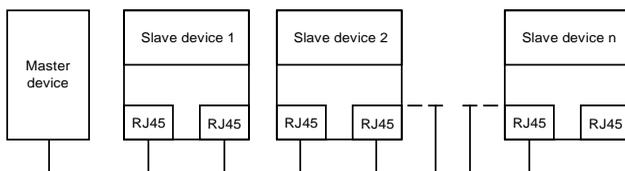
Схема электрических соединений топологии «Шина»
