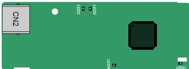
Для подключения платы связи EC-TX504 используются стандартные разъемы RJ45. Описание индикатора
