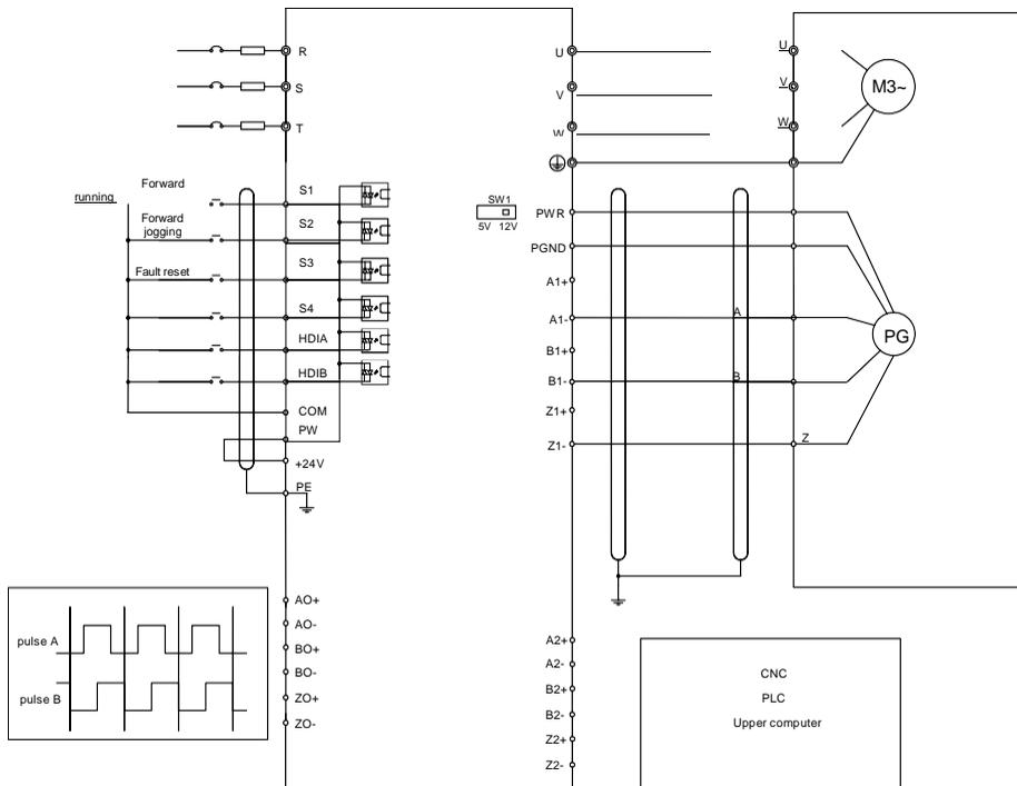
На следующем рисунке показана внешнее подключение платы расширения, используемой в сочетании с дифференциальным энкодером.
