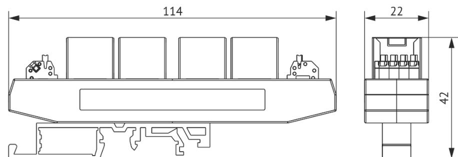
Рисунок 1.12. Габаритные размеры EX6RJТ
