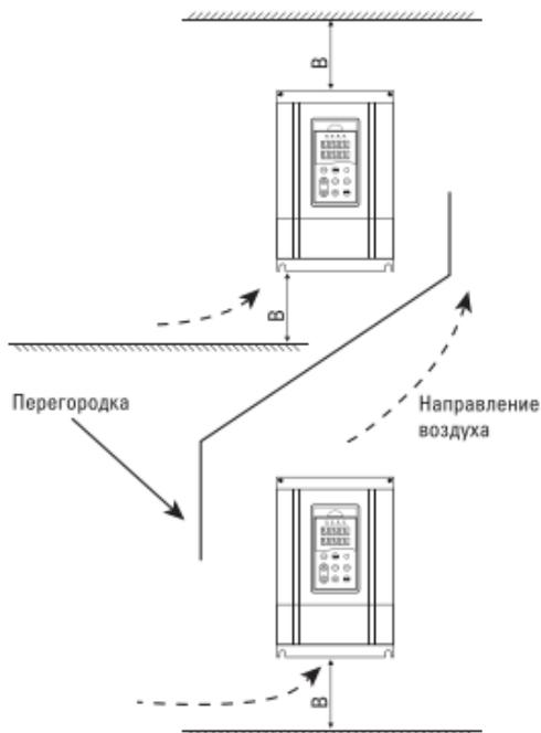
Рис.5 Монтаж при вертикальной установке нескольких преобразователей
