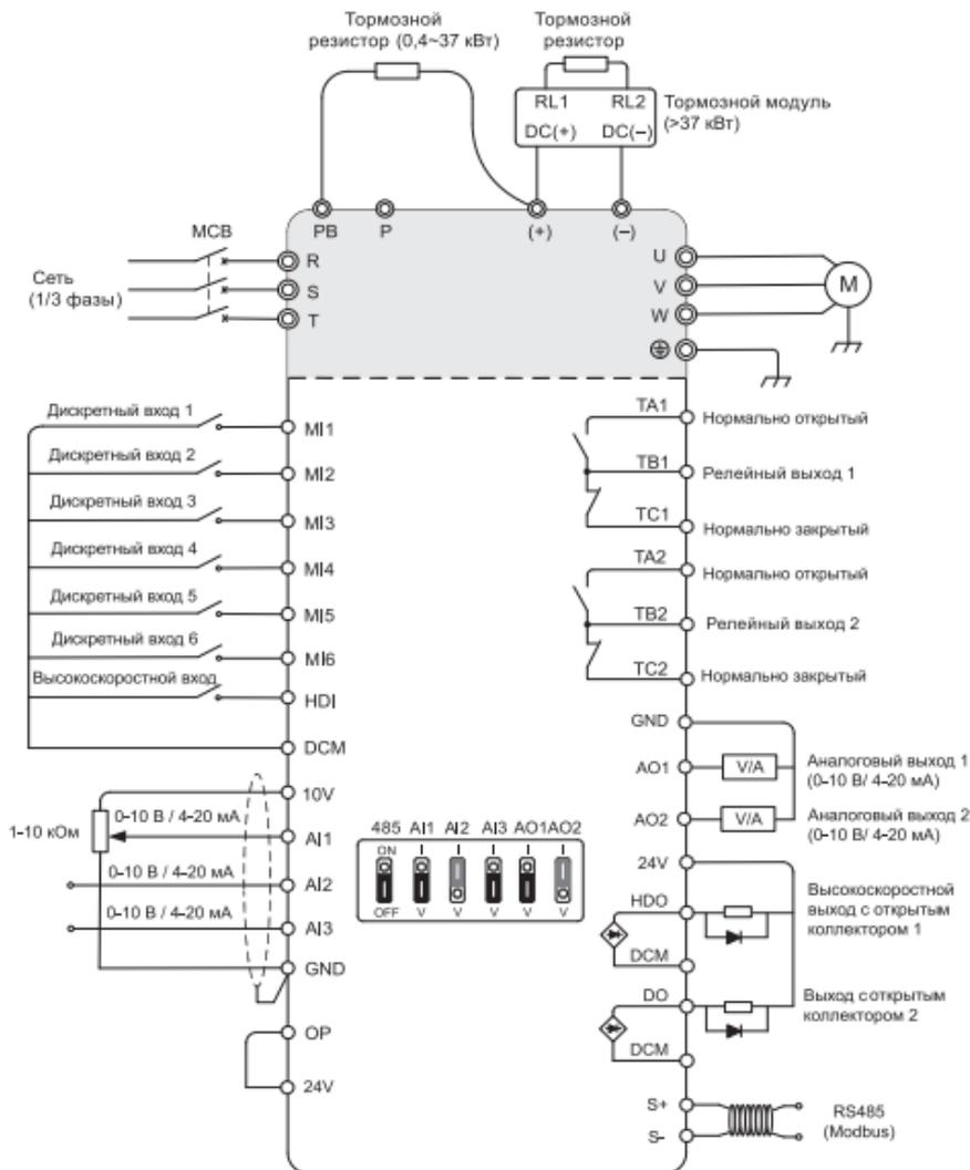
Рис.7. Схема подключения преобразователей частоты VECTOR-100 от 11 кВт
