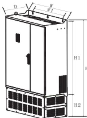
Рис. 3 Габаритные размеры преобразователей частоты VECTOR-100 от 30 кВт
