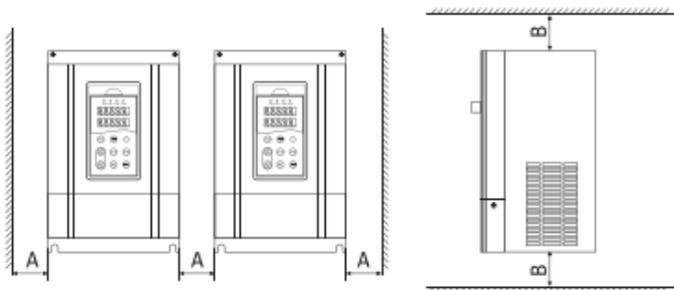
Рис.4 Монтаж при параллельной установке нескольких преобразователей
