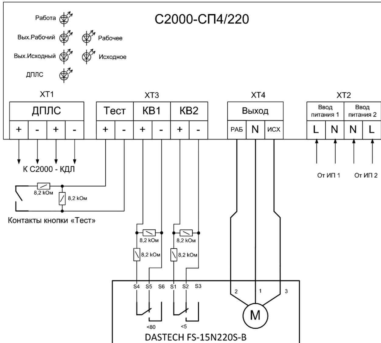
Рекомендуемая схема для привода FS-10N220S-B и FS-15N220S-B при применении с блоком C2000-СП4/220 версии 1.15.
