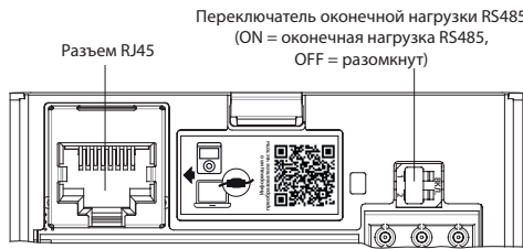
Рис. 4. Разъем RJ45 и переключатель оконечной нагрузки RS485
