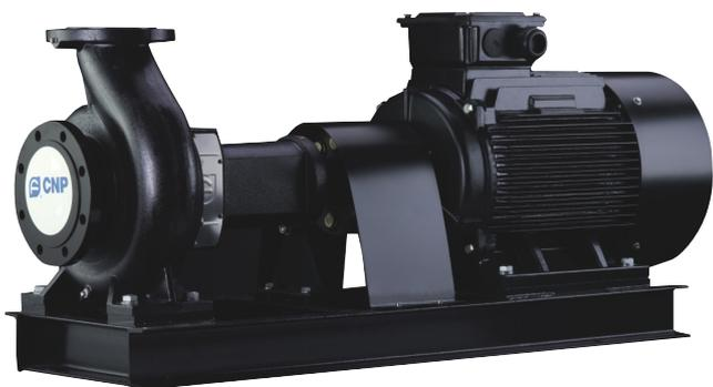
У агрегатов насосных серии NESO насосная часть и электродвигатель разнесены и установлены на единой жесткой стальной раме, передача вращающего момента с вала ротора электродвигателя на вал ротора насоса осуществляется за счет упругой муфты, которая в свою очередь защищена защитным кожухом во избежание нанесения травм обслуживающему персоналу.
