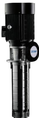
Погружные несамовсасывающие многоступенчатые центробежные электронасосы серии CDLK/CDLKF, оснащены стандартными электродвигателями, вал двигателя соединен непосредственно с валом электронасоса через муфту, при необходимости электронасос может быть оснащен защитой от перегрузки, которая защищает электронасос от «сухого хода», отсутствия фазы и т.д. Чтобы выполнить требование по глубине установки в емкости с водой, можно установить полый корпус для изменения длины электронасоса.
