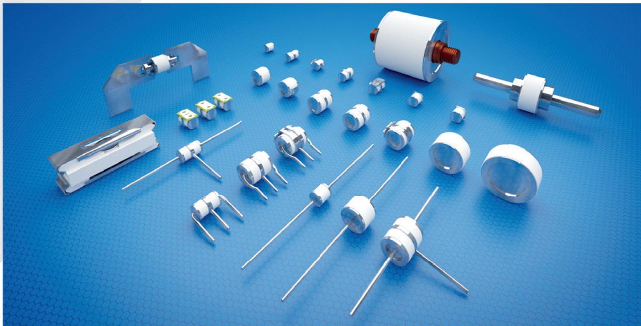
Газовые разрядники – это пассивные компоненты, выполненные из двух или трех электродов в корпусе, наполненном инертным газом при регулируемом давлении. Корпус представляет собой керамическую трубку, концы которой закрыты металлическими колпачками, которые также служат электродами.
