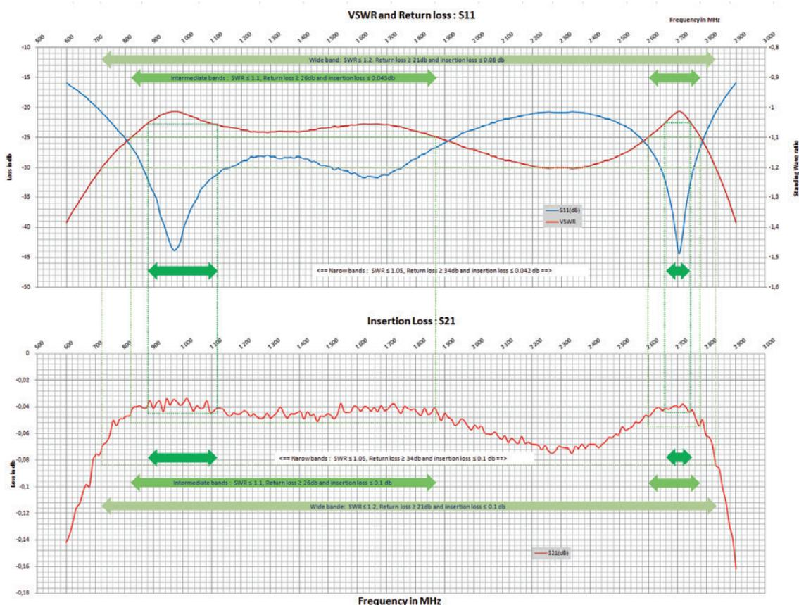
В нашем примере, если запрошенная рабочая полоса частот составляет от 2,7 ГГц до 2,72 ГГц, выбранный УЗИП демонстрирует исключительные радиочастотные характеристики в этом диапазоне частот ( $V_{SWR} < 1,05$ ), даже если общие характеристики указывают, что  $V_{SWR}$  (КСВ) находится в диапазоне от 1 до 1,2. от 0,8 ГГц до 2,8 ГГц.
