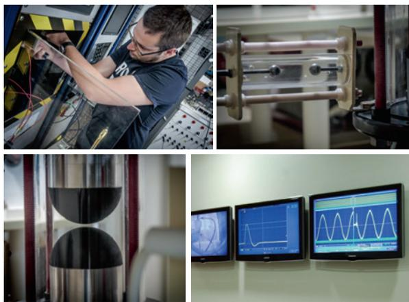
Испытательный генератор G100K в Реймсе (Франция) может производить исключительно высокий импульсный ток 100 кА и используется для тестирования структурных систем молниезащиты, а также устройств защиты от перенапряжения 1-го типа.
