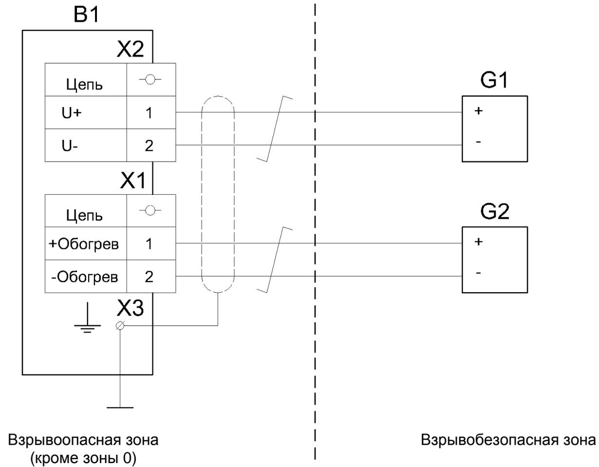
B1 – сигнализатор СУР-16-GAP с токовым выходом и внутренним обогревом в корпусе "С";
