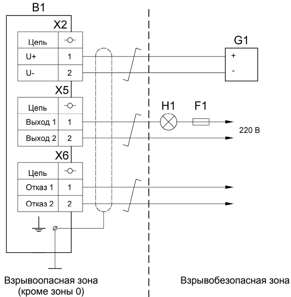
В1 – сигнализатор СУР-16-GAP с релейным выходом в корпусе "С";
