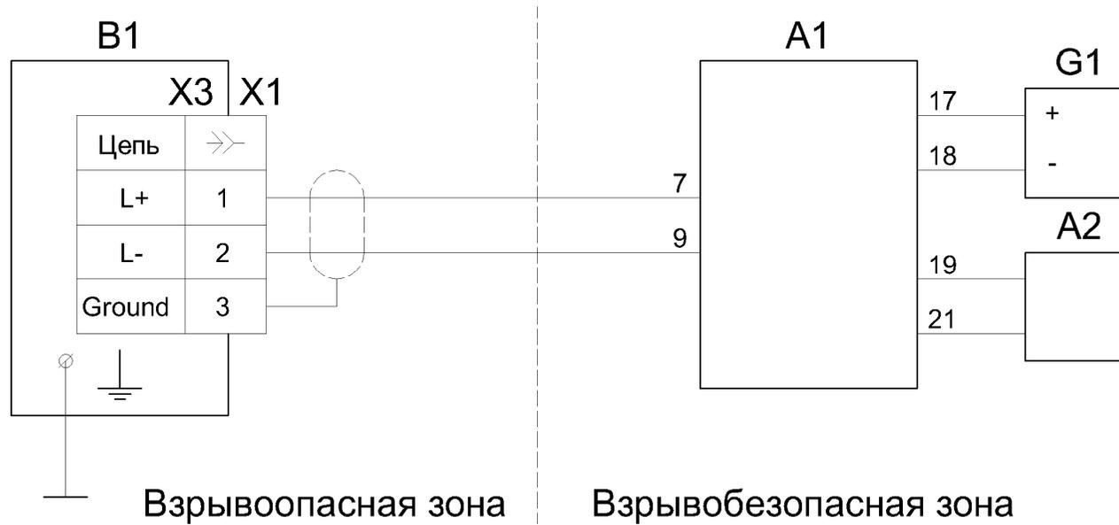
A1 – Ex изолятор (барьер искробезопасности), например БИБ5iH ТУ 4217-057-29421521-09;
