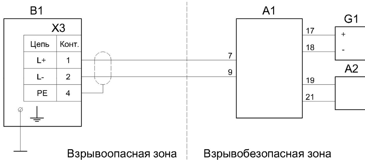
A1 – Ex изолятор (барьер искробезопасности), например БИБ5iH ТУ 4217-057-29421521-09;
