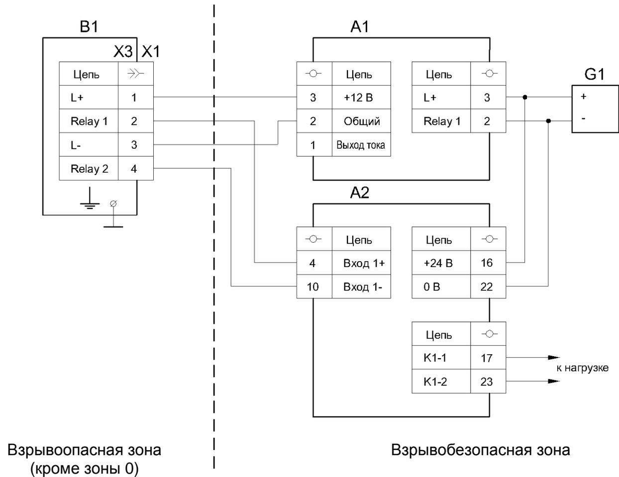
B1 – сигнализатор СУР-16-GAP с релейным выходом в корпусах "Д2", "М12" или "П";
