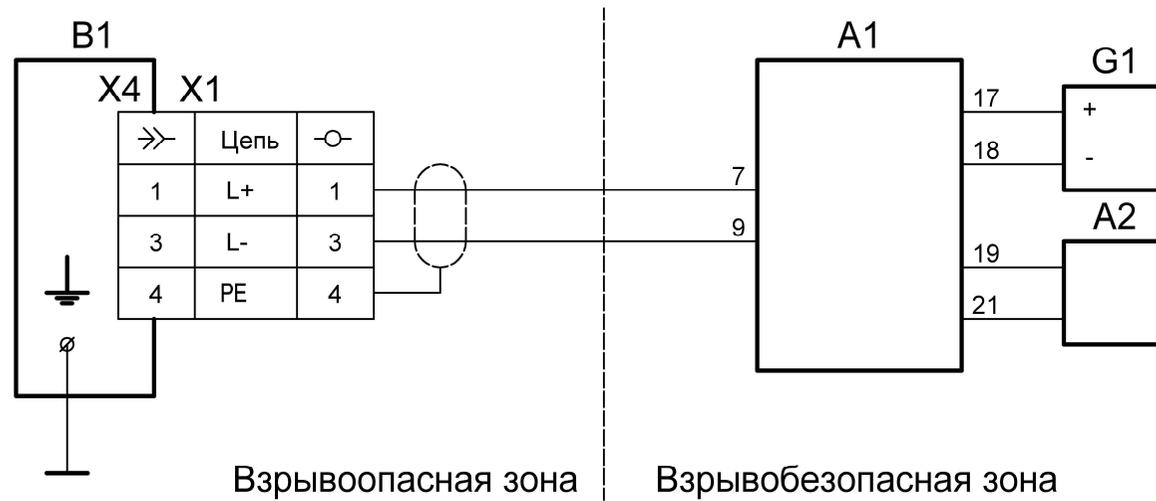
A1 – Ex изолятор (барьер искробезопасности), например БИБ5iH ТУ 4217-057-29421521-09;
