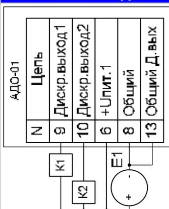
Схема подключения реле к дискретным выходам прибора (внешние цепи гальванически связаны с цепью «Общий»)
