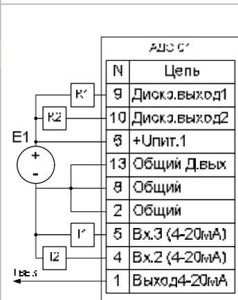
Схема подключения входных сигналов
