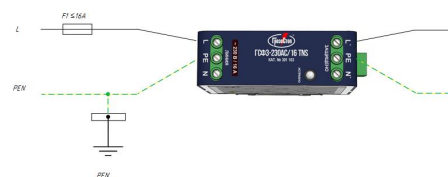
F- Предохранитель, установленный перед устройством
